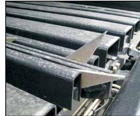
▲ **Os dentes duplos do ejetor** da câmara de fardos vão até a parte traseira para garantir a eliminação total dos fardos durante a limpeza. Os dois conjuntos de ejetores proporcionam o esvaziamento completo da câmara.
