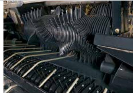
▲ Para obter o máximo de flexibilidade e densidade do fardo, a Case IH oferece de série o **rotor picador**, que possibilita o corte da palha em partículas menores, produzindo fardos de alta densidade.
