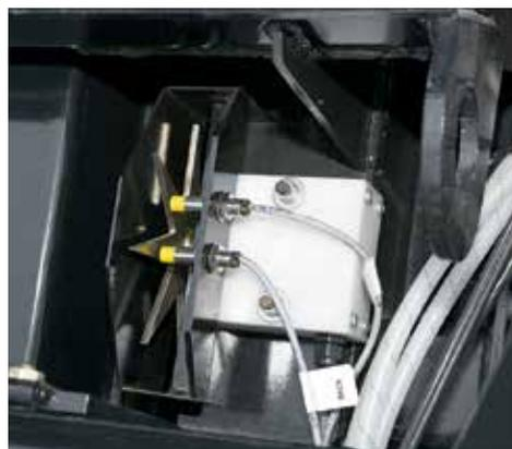
▲ **Há 17 sensores** que transmitem informações sobre o funcionamento da enfardadora no visor na cabine para manter o operador informado sobre a umidade do fardo, a carga do êmbolo, o desempenho do atador, quando um fardo é solto e muito mais (sensores de umidade exibidos).
