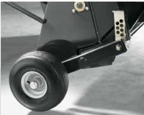
▶ **As rodas reguladoras de coleta** ajustam-se facilmente sem a necessidade de ferramentas.
