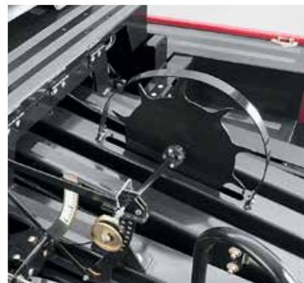
▲ É muito mais fácil empilhar e rebocar fardos do comprimento desejado. O **kit eletrônico de comprimento do fardo (opcional)** permite que o operador ajuste o comprimento do fardo enquanto está sentado no trator. Uma roda estrelada mede o movimento do fardo na câmara para garantir um comprimento preciso.
