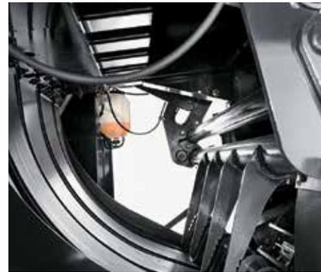
▲ **O maior tempo e a velocidade** de enchimento aceleram a cultura na câmara de fardos para produzir fardos com forma e comprimento mais consistentes e com melhor enchimento nos cantos e na parte superior.
