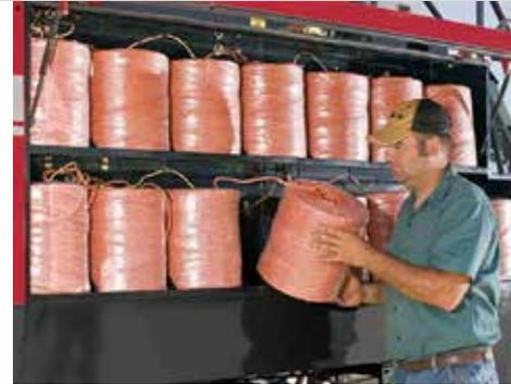
▲ A capacidade de armazenamento para 30 rolos de fios é o suficiente para um longo dia de trabalho sem interrupções.
