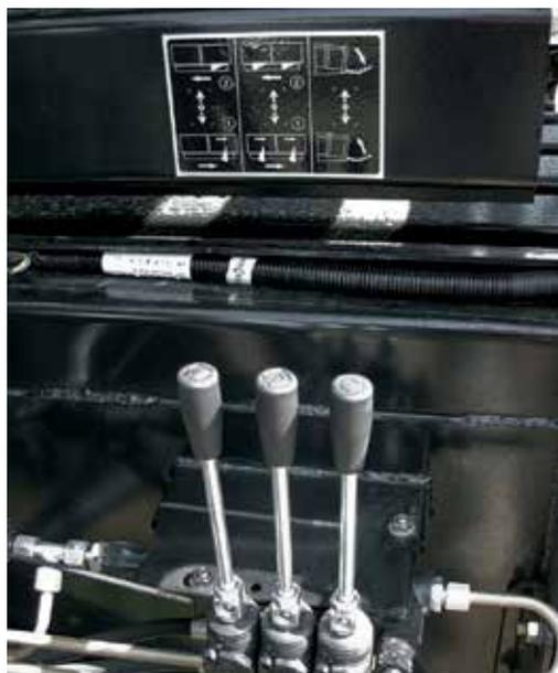
▲ **O novo sistema de ejeção de fardo duplo usa duas alavancas.** Uma delas ejeta o fardo que está mais no fundo. Assim, é possível dobrar a calha do rolamento da enfardadora e deslocar-se para o próximo campo. A segunda alavanca esvazia toda a câmara de fardos quando está na hora de se mover para o próximo trabalho ou ao seu término.
