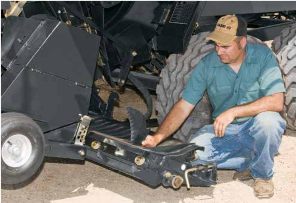
**O compartimento de facas em forma de gaveta** oferece acesso livre para inspecionar, afiar ou alterar as facas. As facas, rígidas e resistentes ao desgaste por fricção, proporcionam uma longa vida útil e são acionadas hidráulicamente do assento do trator, de modo que seja possível picar ainda mais o material.
